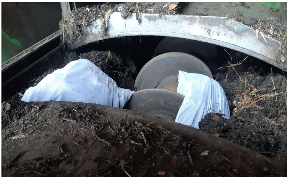
Obrázok 4.9: Umiestnenie vzorkových vriec do kompostovacieho suda
