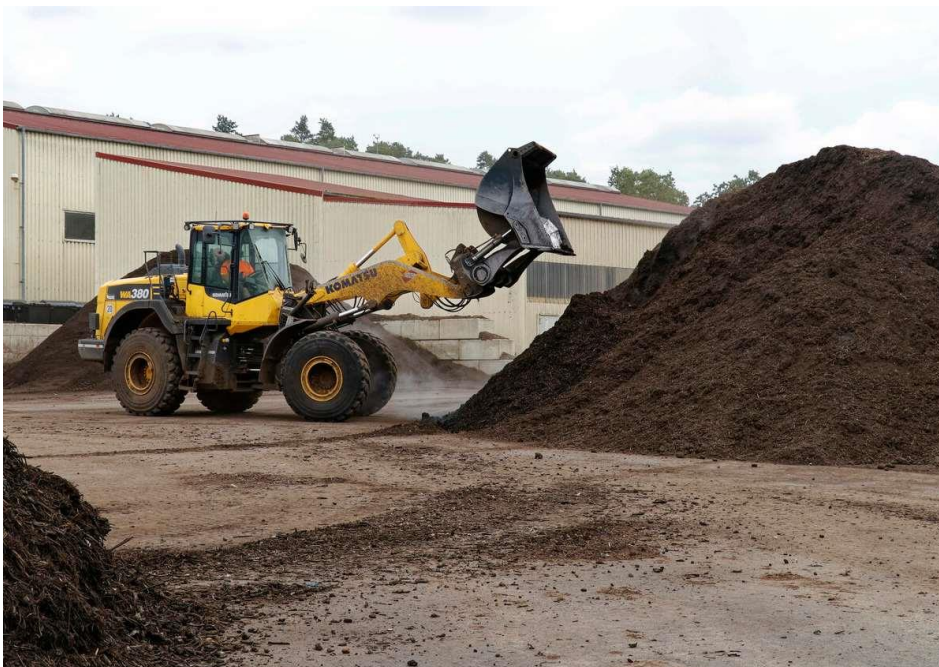
Obrázok 3.3: Ukladanie bioodpadu na kompostovacu hromadu kolesovým nakladačom
